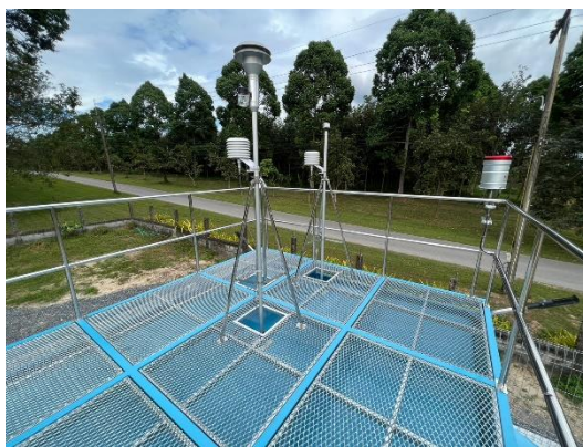
รูปที่ 3 สถานีตรวจวัดคุณภาพอากาศแบบต่อเนื่อง (AQMS)
